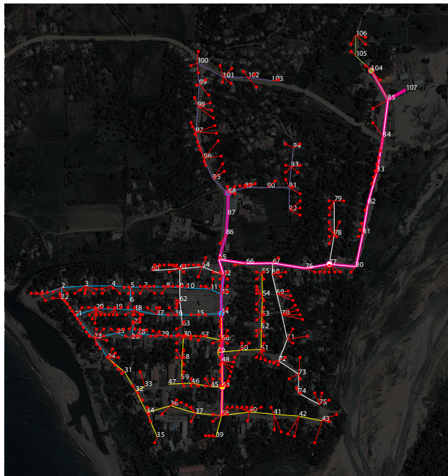
Figure 2: Les Anglais grid topology
